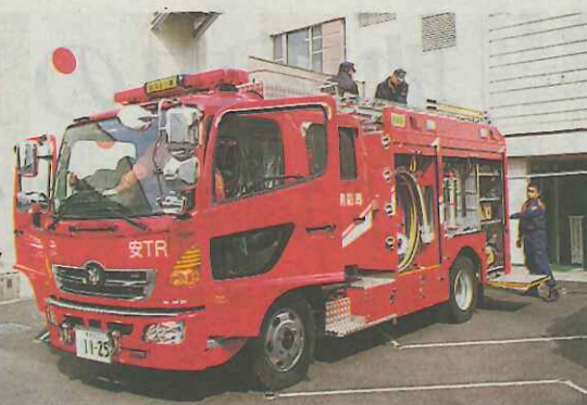
安茂里分署に配備されたタンク工作車。水槽を搭載しているほか、事故車両を持ち上げるための「マツト型空気ジャッキ」や、車内に閉じ込められた人を救出する際に使う救助器具といった資機材を積んでいる。
